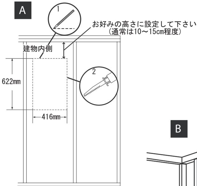
A: 角窓(小)の開口寸法は幅416mm高622mmとなります。窓を取り付けたい場所に建物内側から鉛筆等でこの寸法通りに線を引いて下さい。(図A)
