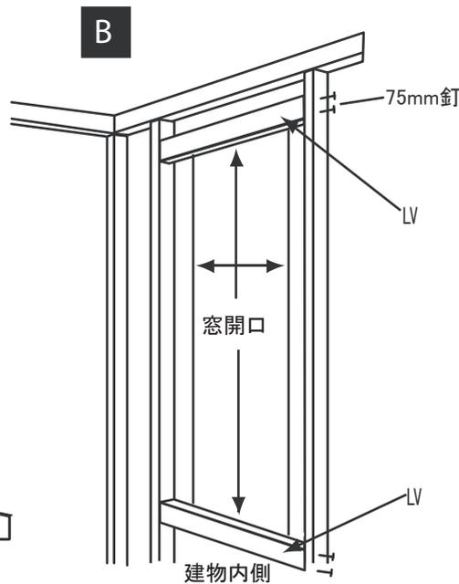
B: 建物内側の窓開口上下に(LV)を当て75mm釘で固定します。(図B)
