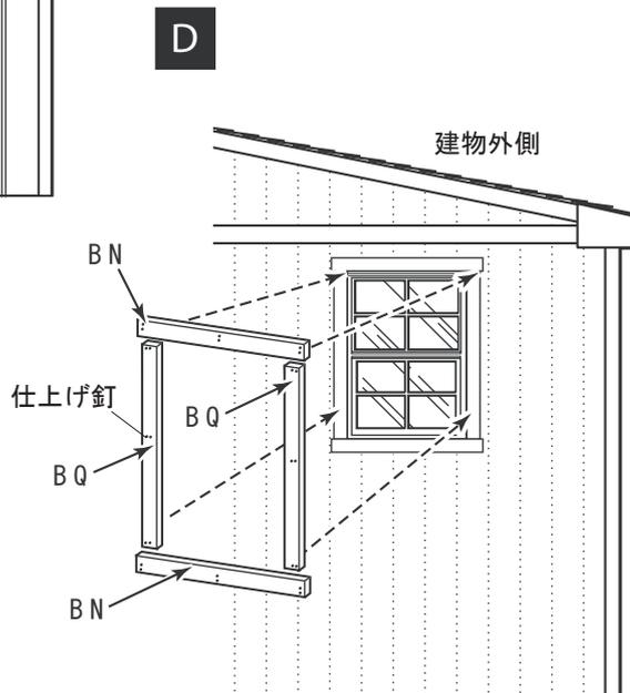
D: 建物外側から窓の上下・左右に化粧板(BN)(BQ)を仕上げ釘で打ち付けて下さい。(図D)
