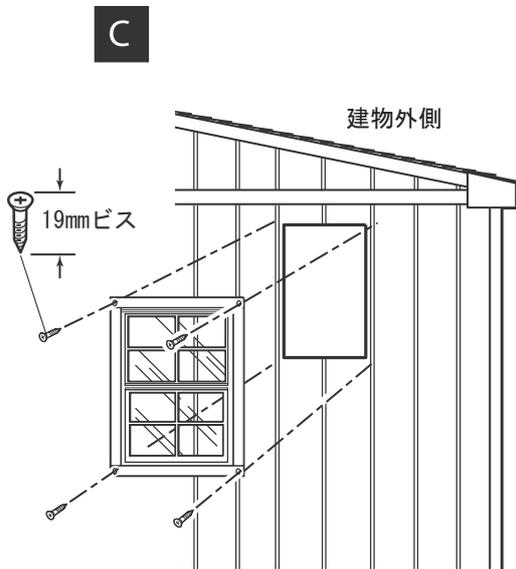
C: 窓を建物の外側からはめ込み、19mmビスで四隅を固定します。この時、窓をはめ込む前に開口部の縁にコーキング材を打つことをお勧めします。(図C)
